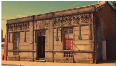
**Casa Setti.** Su característica más relevante son sus frisos de granitos en sobrerrelieve por encima de los dos paños laterales y los puentes de acceso. En su fachada se notan los elementos de piedra: los muros son de albañilería de ladrillo de doble hilado; techumbre de madera y cubierta de tejas de madera. Es una típica casa de familia del centro histórico de la ciudad de la primera parte del siglo XX. Hoy, en el año 2014, aún sigue en pie... apreciando el tiempo.
